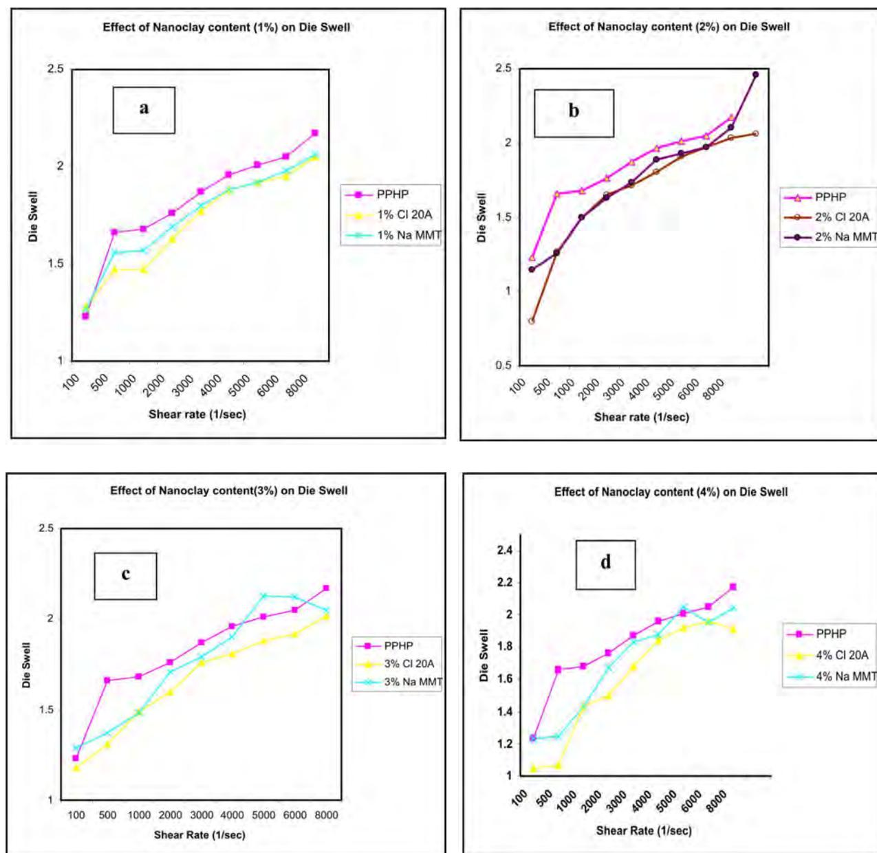
Fig. 4: Die Swell vs Shear Rate of PPNCs; (a) 1 wt. %, (b) 2 wt. %, (c) 3 wt. % and (d) 4 wt. %
